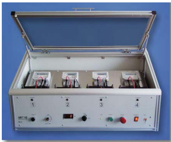
Skúšačka AMVT na 4 ks elektromerov
