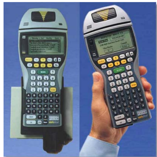
Hardvér ručného počítačového terminálu (PSION Workabout)
